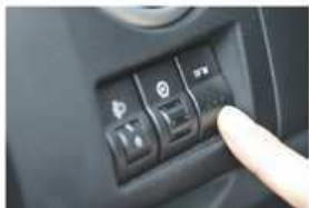
Deaktivaci zubové spojky pro pohon předních kol učiníte stiskem tlačítka RFW
