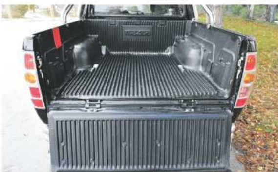
Víko ložného prostoru lze po odjištění úchytných lanek sklopit až k nárazníku
