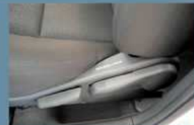
Sklon opěradla a výškové seřizování sedadla probíhá „pumpováním“
