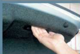
Vnitřní madlo výrazně omezí zašplnění ruky při zavírání víka
